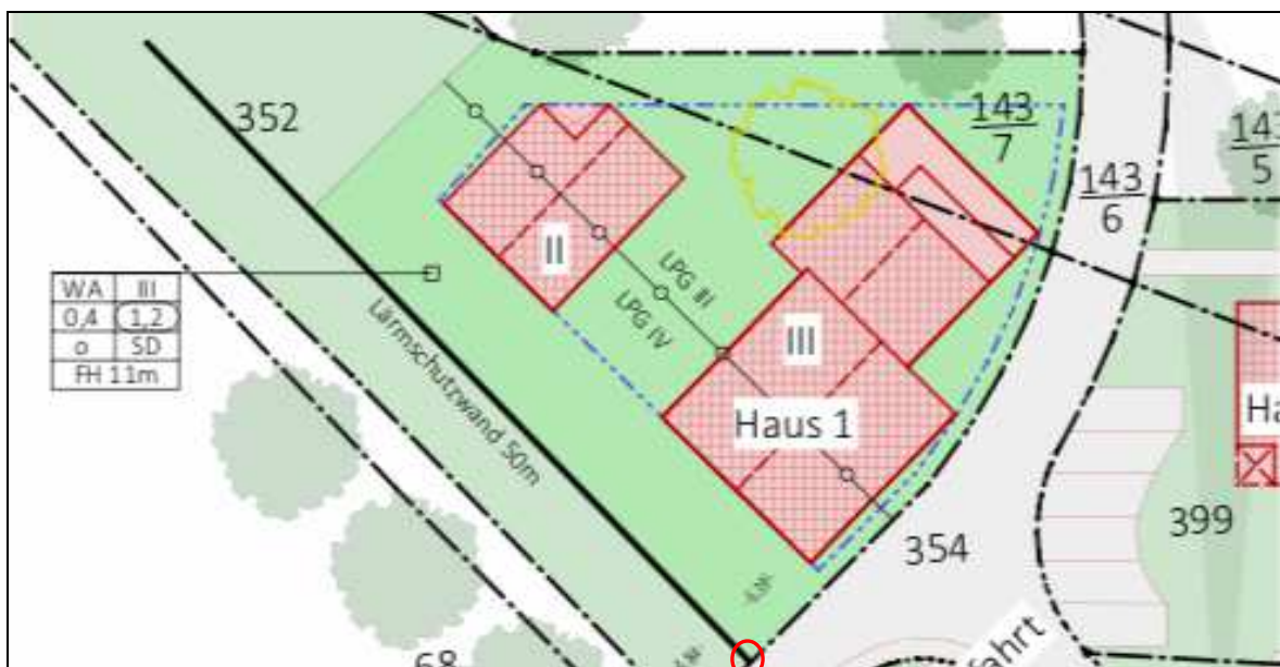
Abbildung 2: Skizze mit möglichem Standort der Lärmschutzwand (hier noch mit einer Länge von 50 m) mit Bezugspunkt im roten Kreis (unten)
